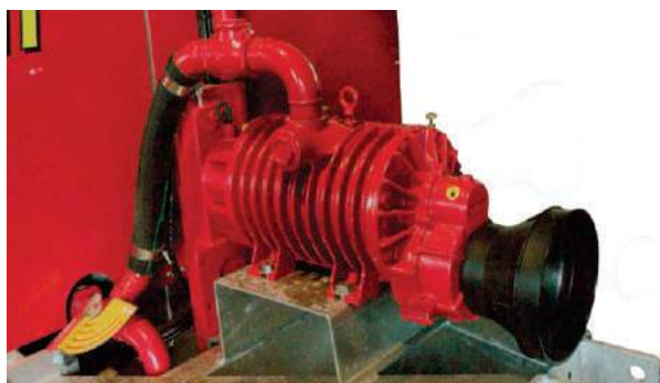
کمپرسور خلاء جهت تخلیه قاب داخل لوله
